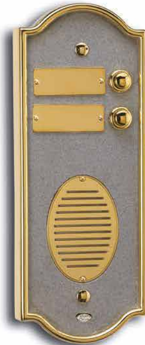
ART. 2121 - 1 pulsante ART. 2122 - 2 pulsanti ART. 2123 - 3 pulsanti Pulsantiera citofonica in pietra con cornice in ottone lucido naturale mm 100x250x20
